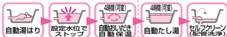
ふろ設定温度で、設定水位まで自動湯はり。残り湯があるときでも、設定水位まで自動湯はり。
