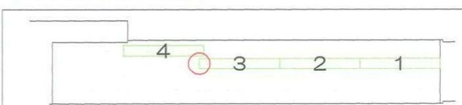
3の建具上部のつまみ金具を上げ、一直線壁の建具を固定する。
