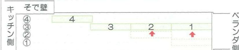
そで壁との隙間が生じないように、建具4を出入口とする。
