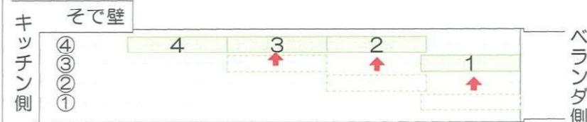
そで壁との隙間が生じないように、④の溝に2・3の建具を並びかえる。
