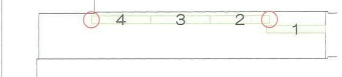
2及び4の建具上部のつまみ金具を上げ、一直線壁の建具を固定する。
